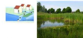
Wadi Bufferings - infiltratievoorziening met regenwater. Een moderne wadi wordt in stevige gebieden, straten en daken afgekoppeeld van de riolering. Het regenwater wordt via een regenwaterleiding of over maaiveld afgevoerd naar een wadi. Waar het kan infiltreren in de bodem, of vertraagd kan worden afgevoerd naar oppervlaktewater. Op deze manier wordt voorkomen dat schoon water naar de rioolwaterzuiveringsinstallatie wordt afgevoerd, wat ten goede komt aan de duurzame ontwikkeling binnen dit gebied.
