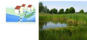
Wadi Bufferings - infiltratievoorziening met regenwater. Een moderne wadi wordt in stevige gebieden, straten en daken afgekoppeeld van de riolering. Het regenwater wordt via een regenwaterleiding of over maaiveld afgevoerd naar een wadi. Waar het kan infiltreren in de bodem, of vertraagd kan worden afgevoerd naar oppervlaktewater. Op deze manier wordt voorkomen dat schoon water naar de rioolwaterzuiveringsinstallatie wordt afgevoerd, wat ten goede komt aan de duurzame ontwikkeling binnen dit gebied.
